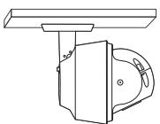
请用户按照说明书方式正确安装，禁止错误方向安装，否则存在因进水导致设备报废风险！
