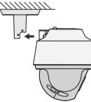
(3) 在下图位置两侧都打入自攻螺钉，将摄像机与支架固定。
